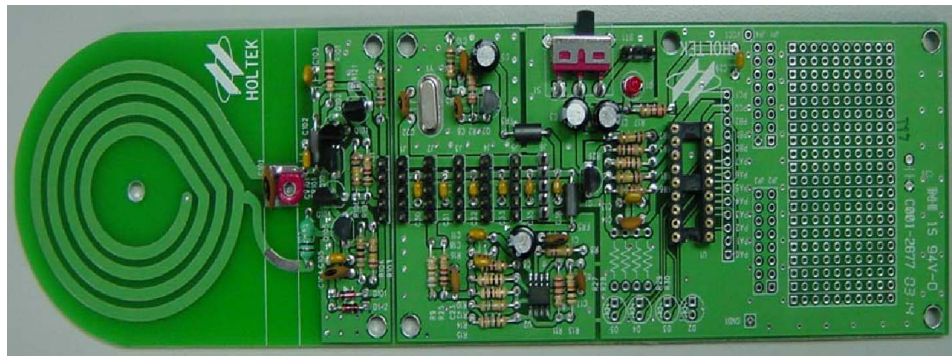
RFID 公版实作图(2~6 个天线)
