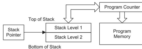
如果堆栈已满，且有非屏蔽的中断发生，中断请求标志会被置位，但中断响应将被禁止。当堆栈指针减少 (执行 RET 或 RETI)，中断将被响应。这个特性提供程序设计者简单的方法来预防堆栈溢出。然而即使堆栈已满，CALL 指令仍然可以被执行，而造成堆栈溢出。使用时应避免堆栈溢出的情况发生，因为这可能导致不可预期的程序分支指令执行错误。
