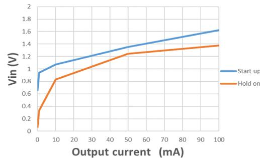
$V_{IN}=0.6 \times V_{OUT}$ ,  $C_{IN}=47\mu F$ ,  $C_{OUT}=22\mu F$ ,  $L=47\mu H$ ,  $T_a=25^\circ C$ ,  $R_1=0.15\Omega$ , 除非另有说明
